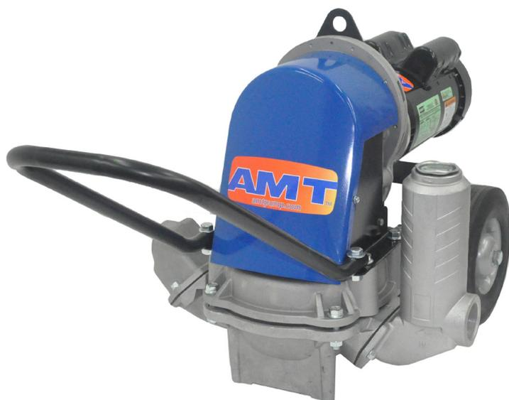
Diese Baureihe der AMT Membranpumpen ist mit einem 2-stufigen, geschmiedeten Zahnradgetriebe für hohe Belastungen ausgestattet. AMT Membranpumpen sind für die Förderung von Wasser, Matsch, Schlämmen, Abwasser und dickflüssigen Medien ausgelegt.
